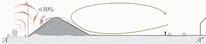
Geluidswal Polygoonstraat: asymmetrisch profiel i.f.n. geluid en parkebeleving
