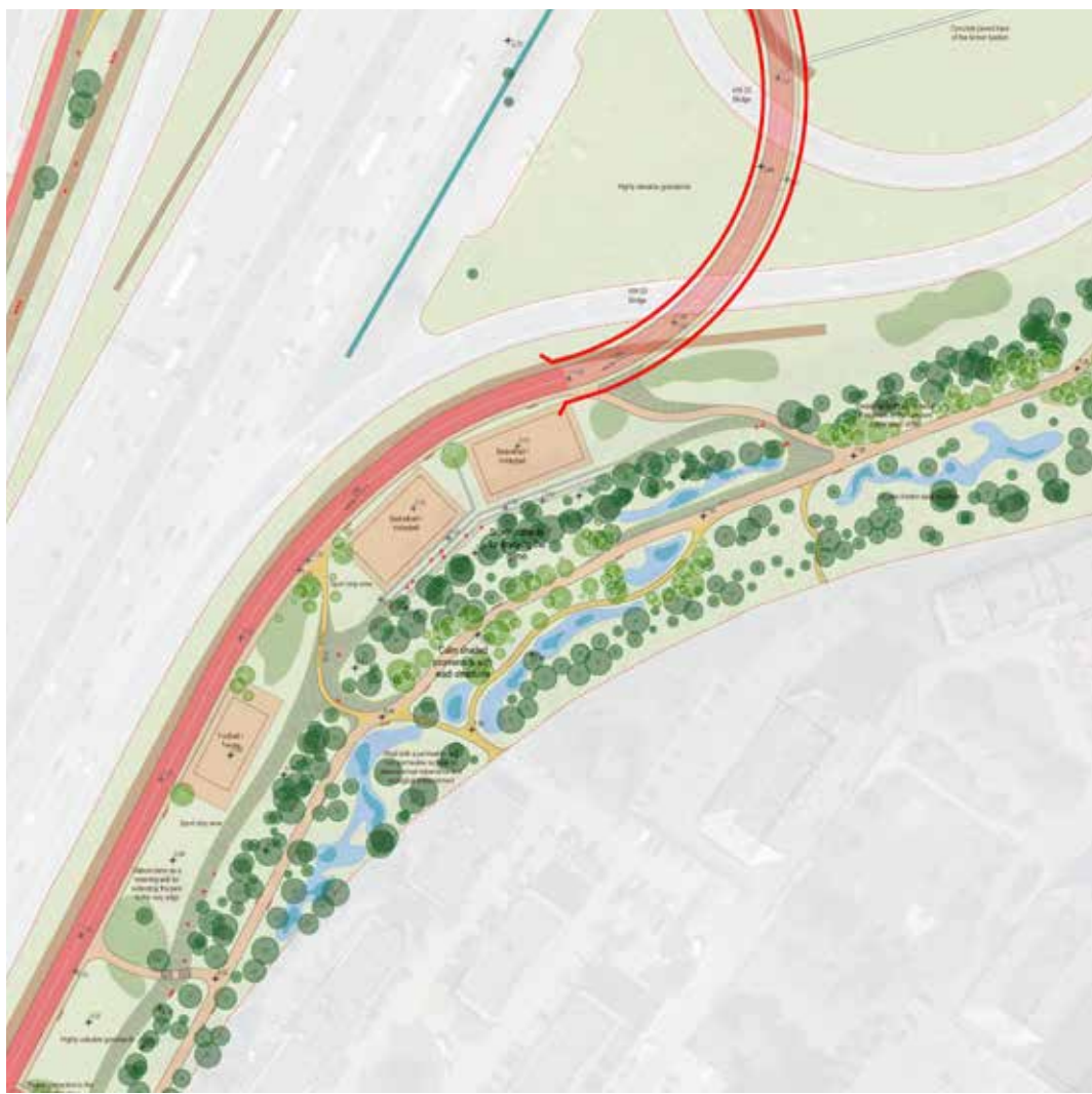
Een netwerk van wadi's kan mee het afstromend regenwater van de omliggende wijken opvangen. © Ontwerpteam Ringpark Groene Vesten
